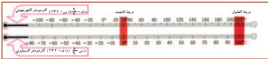
شكل (١٤) النظام السيليزي والنظام الفهرنهايتي لقياس درجة الحرارة
