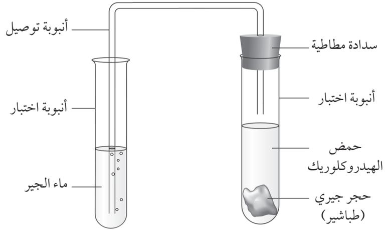
الشكل ٥-١: رسم تخطيطي لجهاز يوضح نواتج التجوية الكيميائية للصخور الكربونية.
