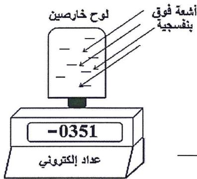
(20) الشكل المقابل يمثل عداد إلكتروني يستخدم لحساب الإلكترونات المتحررة من سطح فلز في دراسة ظاهرة التأثير الكهروضوئي.
