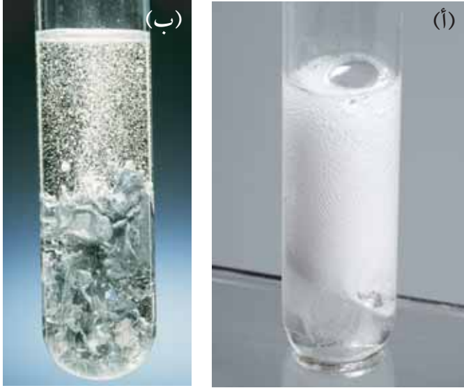
الصورة ٨-١ تفاعل حمض الهيدروكلوريك مع (أ) شريط ماغنيسيوم (ب) مع حبيبات الخارصين، مُنتجًا غاز الهيدروجين
