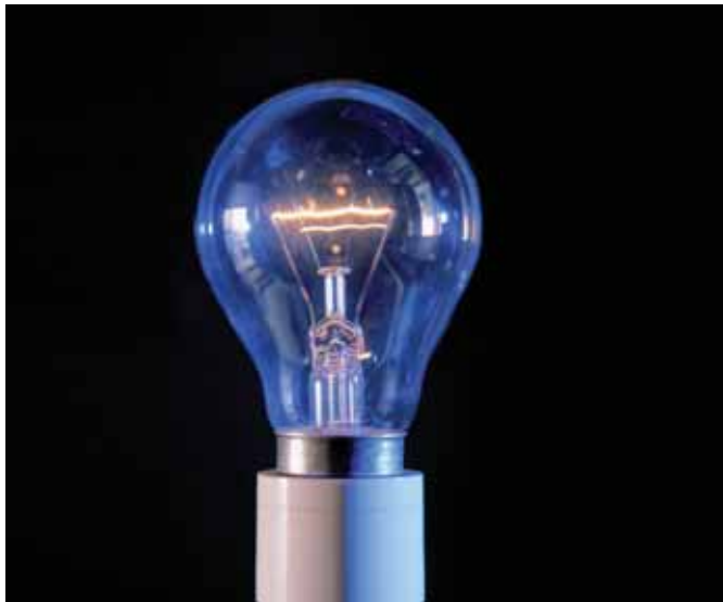
الصورة ١٠-١ تحتوي المصابيح الكهربائية ذات الأسلاك المعدنية على الأرغون، الذي لا يتفاعل مع أسلاك التنجستن الساخنة
