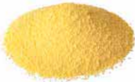
عَيِّنة من عنصر الكبريت، تستخدم لصنع حمض الكبريتيك الذي هو أساس العديد من المواد الكيميائية، مثل الأصباغ والمبيدات الحشرية
