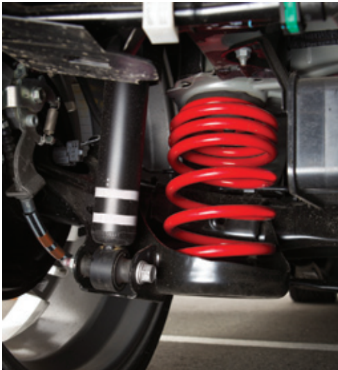
الصورة ٧-٥ الزنبركات وممتصات الصدمات في السيارة تشكّل نظام تعليق مخمد.
