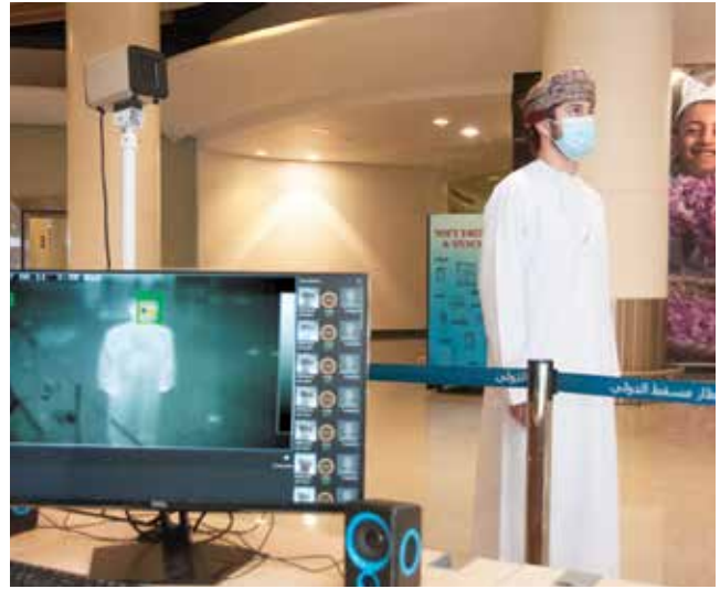
الصورة ٩-٤ كاميرا استشعار للأشعة تحت الحمراء في مطار مسقط الدولي تظهر الاختلافات الطفيفة في درجة حرارة الجسم
