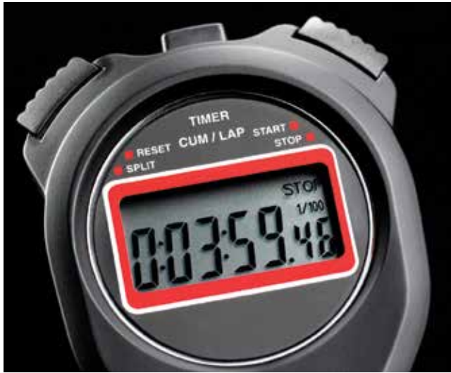
الصورة ١-٣ يمكن لساعة الإيقاف الرقمية هذه قياس الفترات الزمنية التي تتراوح بين 0.01 ثانية و 10 ساعات
