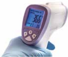
الصورة ٧-١ ميزان حرارة مصنوع من البلاستيك والفلز مع شاشة من السائل البلّوري
