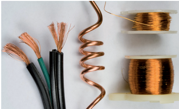
يُستخدم النحاس في صناعة الأسلاك الكهربائية؛ لأنه موصل جيد للكهرباء ومرن.
