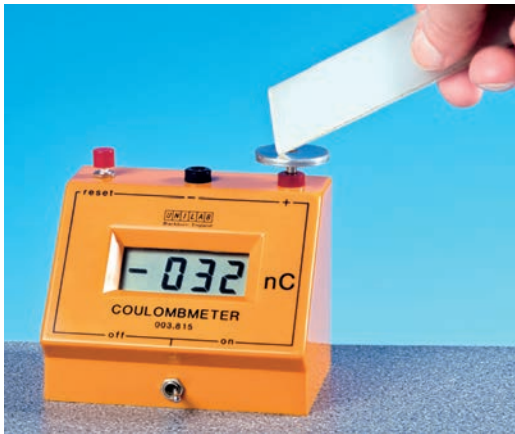
إيجاد نوع الشحنة الكهربائيّة باستخدام جهاز قياس الشحنة الكهربائيّة
