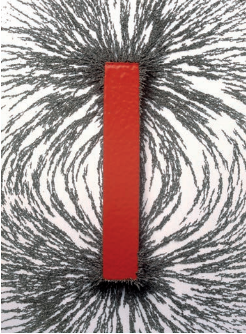
تُبين صورة برادة الحديد أن المجال المغناطيسي يكون كثيفاً (أقوى) بالقرب من القطبين.
