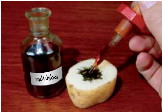
الصورة ٣-٢ يدلّ اللون الأزرق المائل إلى الأسود على أن البطاطس تحتوي على النشا
