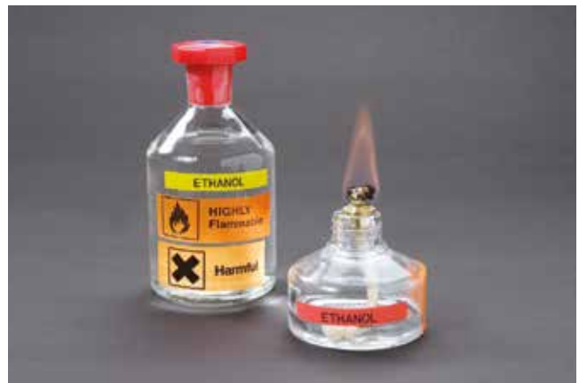
الصورة ٧-٢ موقد كحولي يستخدم الإيثانول. يحترق الإيثانول بلهب نظيف إلى حد ما، مطلقاً القليل من الدخان نسبياً
