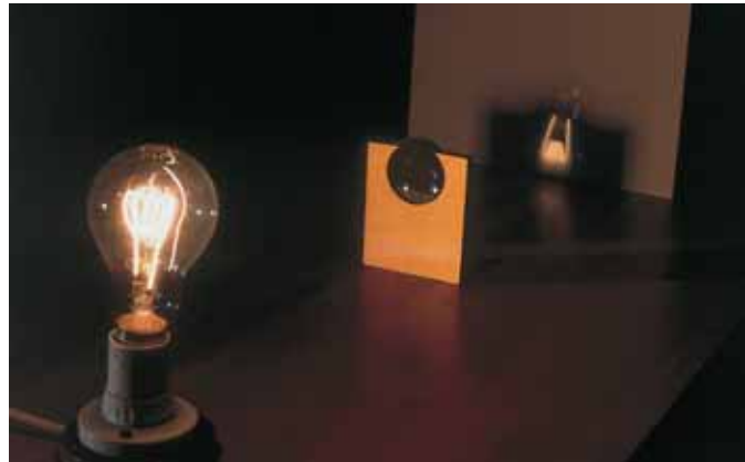
الصورة ١٤-٢ تكوين صورة حقيقية لفتيل مصباح كهربائي باستخدام العدسة المحدبة. تظهر الصورة مقلوبة على الشاشة
